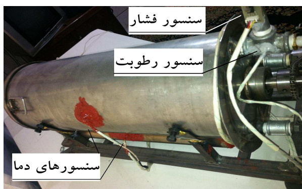
شکل ۱ شماتیک دستگاه و محل قرارگیری سنسورهای دما، فشار و رطوبت
