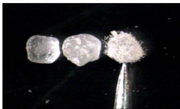
شکل ۵ مقایسه بلور اسید سیتریک تیمار نشده (چپ)؛ اسید سیتریک آغشته به کربوکسی متیل سلولز رشته ای (وسط)؛ بلور اسید سیتریک پوشش دار شده با کربوکسی متیل سلولز رشته ای (راست) توسط امواج مایکروویو در مدت ۳۰۰ ثانیه (تصویربرداری شده توسط دوچشمی آزمایشگاهی با بزرگ‌نمایی ۱/۵).
