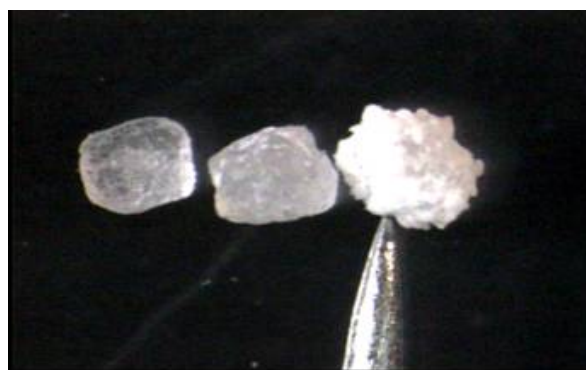
شکل ۴ مقایسه بلور اسید سیتریک تیمار نشده (راست)؛ اسید سیتریک آغشته به سوربیتول (وسط)؛ بلور اسید سیتریک پوشش دار شده با سوربیتول (راست) توسط امواج مایکروویو در مدت ۱۰۰ ثانیه (تصویربرداری شده توسط دوچشمی آزمایشگاهی با بزرگ‌نمایی ۱/۵).
