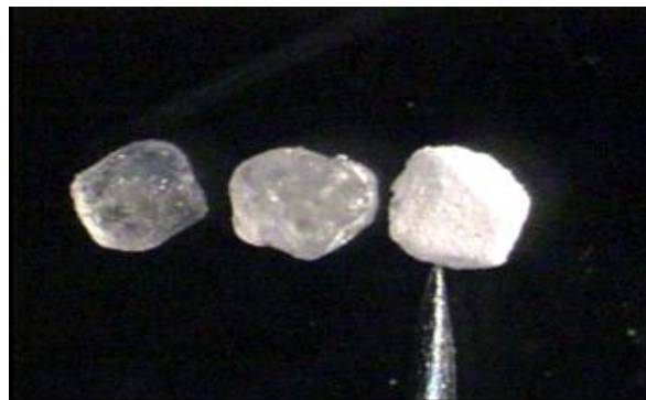
شکل ۳ مقایسه بلور اسید سیتریک تیمار نشده (چپ)؛ اسید سیتریک آغشته به پودر کازئین (وسط)؛ و بلور اسید سیتریک پوشش دار شده با کازئین (راست) توسط امواج مایکروویو در مدت ۲۵۰ ثانیه (تصویربرداری شده توسط دوچشمی آزمایشگاهی با بزرگ‌نمایی ۱/۵).
