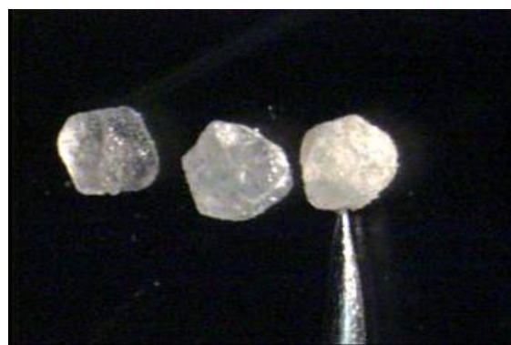
شکل ۷ مقایسه بلور اسید سیتریک تیمار نشده (راست)؛ اسید سیتریک آغشته به پکتین با درجه متوکسیل پایین (۹/۵٪) (وسط)؛ بلور اسید سیتریک پوشش دار شده با پکتین با درجه متوکسیل پایین (۹/۵٪) (راست) توسط امواج مایکروویو در مدت ۲۰۰ ثانیه (تصویربرداری شده توسط دوچشمی آزمایشگاهی با بزرگ نمایی ۱/۵).
