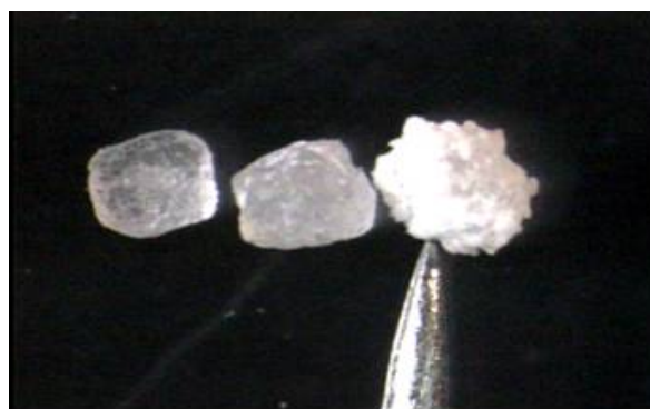
شکل ۴ مقایسه بلور اسید سیتریک تیمار نشده (راست)؛ اسید سیتریک آغشته به سوربیتول (وسط)؛ بلور اسید سیتریک پوشش دار شده با سوربیتول (راست) توسط امواج میکروویو در مدت ۱۰۰ ثانیه (تصویربرداری شده توسط دوچشمی آزمایشگاهی با بزرگنمایی ۱/۵).
