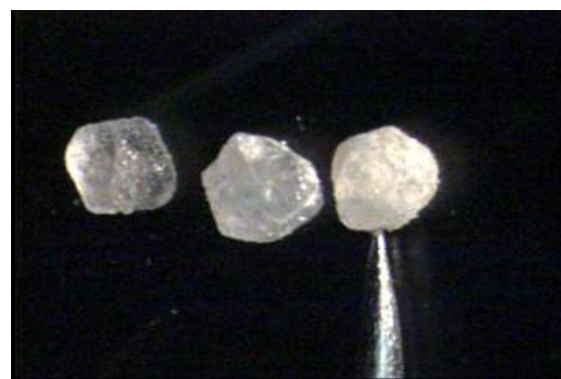
شکل ۷ مقایسه بلور اسید سیتریک تیمار نشده (راست)؛ اسید سیتریک آغشته به پکتین با درجه ی متوکسیل پایین (۹/۵٪) (وسط)؛ بلور اسید سیتریک پوشش دار شده با پکتین با درجه ی متوکسیل پایین (۹/۵٪) (راست) توسط امواج مایکروویو در مدت ۲۰۰ ثانیه (تصویربرداری شده توسط دوچشمی آزمایشگاهی با بزرگ نمایی ۱/۵).
