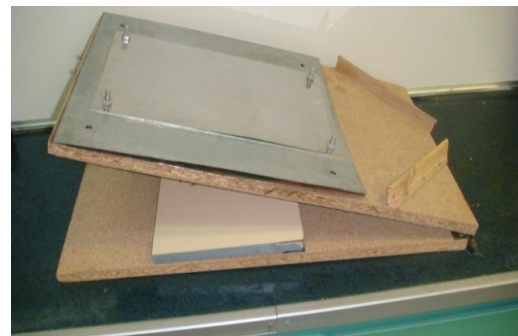
شکل ۱ دستگاه اندازه‌گیری ضریب اصطکاک استاتیکی
