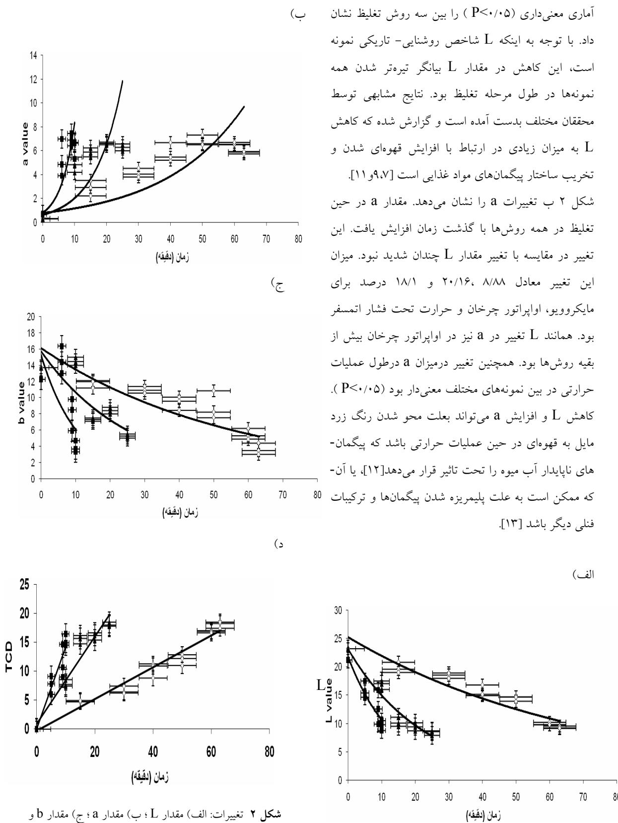
شکل ۲ تغییرات: (الف) مقدار  $L^*$ ؛ (ب) مقدار  $a^*$ ؛ (ج) مقدار  $b^*$  و (د) TCD کسانتره انجیر تولید شده با روش‌های مختلف تغییر (◊) حرارت تحت فشار اتمسفر، ▲ حرارت در اواپراتور چرخان تحت خلا و ■ حرارت در مایکروویو و — مدل پیش‌بینی شده
