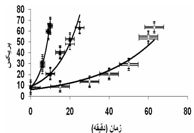
شکل ۱ تغییرات غلظت ایجاد شده با روش‌های مختلف تغليظ (○ حرارت تحت فشار اتمسفر، ▲ حرارت در اوپراتور چرخان تحت خلا، ■ حرارت در مايكرووويو و — مدل پيش بیني شده)
