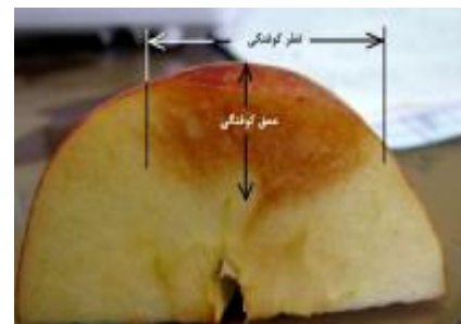
شکل 1 نحوه اندازه گیری ابعاد کوفتگی
