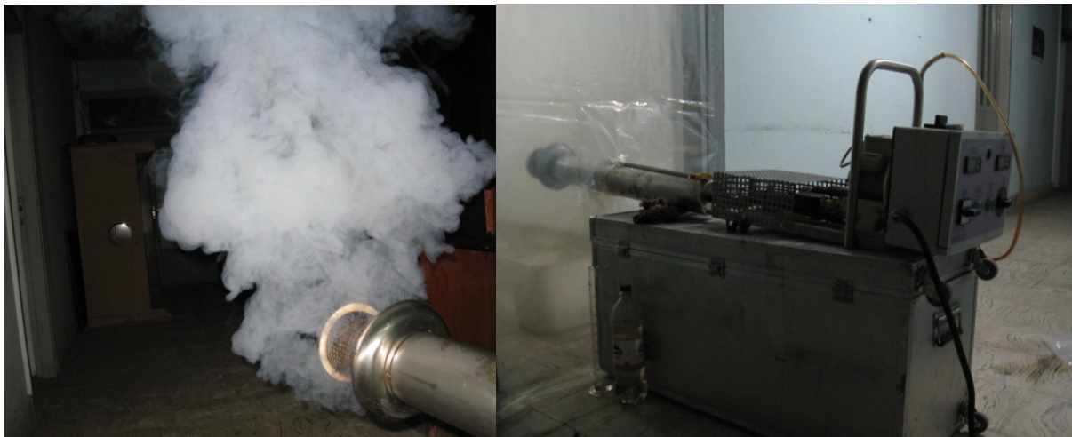
شکل ۱ (الف) دستگاه مه پاش حرارتی در حالت نصب و آماده برای مه پاشی (ب) تولید ذرات در حد نانو از قارچ کش اورتو فنیل فنول (OPP)
