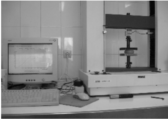
شکل 1 نحوه آزمون نیروی شکست توسط دستگاه آزمون مواد
