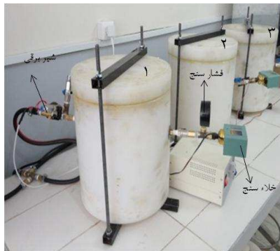
شکل ۱ محفظه‌های خلأ و تجهیزات بکار رفته در آن
