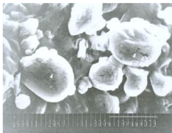
شکل 3 ساختمان میکروسکوپی نان بربری تازه، نواحی دارای شکاف روی گرانولهای نشاسته مشخص شده است
