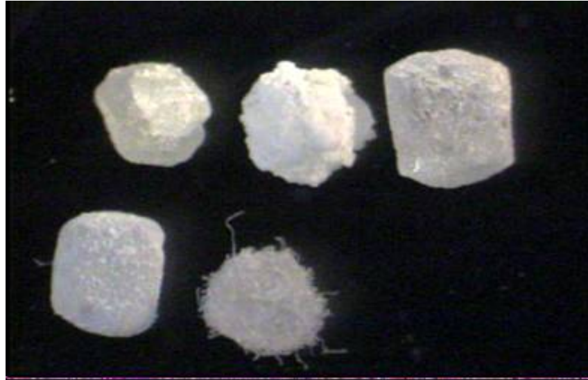
شکل ۸ مقایسه بلورهای اسید سیتریک خوراکی کپسوله شده با اینولین (ردیف بالا سمت راست)، سوربیتول (ردیف بالا وسط)، پکتین (ردیف بالا سمت چپ)، کربوکسی متیل سلولز (ردیف پایین سمت راست) و کازئین (ردیف پایین سمت چپ)، تصویربرداری شده توسط دوچشمی آزمایشگاهی با بزرگ نمایی ۵.
