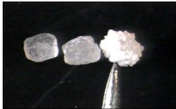
شکل ۴ مقایسه بلور اسید سیتریک تیمار نشده (راست)؛ اسید سیتریک آغشته به سوربیتول (وسط)؛ بلور اسید سیتریک پوشش دار شده با سوربیتول (راست) توسط امواج مایکروویو در مدت ۱۰۰ ثانیه (تصویربرداری شده توسط دوچشمی آزمایشگاهی با بزرگ‌نمایی ۱/۵).
