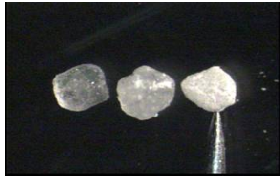
شکل ۶ مقایسه بلور اسید سیتریک تیمار نشده (راست)؛ اسید سیتریک آغشته به اینولین (وسط)؛ بلور اسید سیتریک پوشش دار شده با اینولین (راست) توسط امواج مایکروویو در مدت ۷۵ ثانیه (تصویربرداری شده توسط دوچشمی آزمایشگاهی با بزرگ نمایی ۱/۵).
