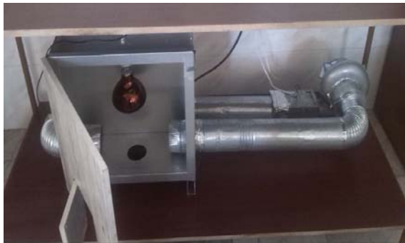
شکل ۱ خشک‌کن ترکیبی مادون‌قرمز- هوای داغ مورد استفاده در این تحقیق.
