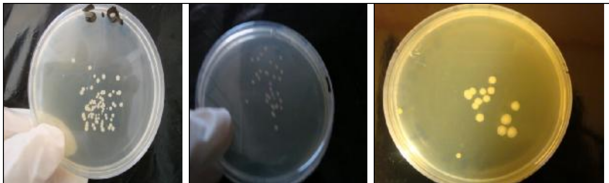
شکل 8 تصاویر پلیت های آزمون بررسی خاصیت ضد میکروبی قطعات سفال محتوی نانو ذرات نقره بر روی استافیلوکوکوس اورئوس به ترتیب از چپ به راست بعد از مدت 4، 8 و 24 ساعت
