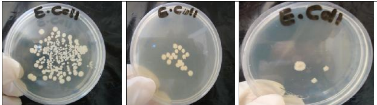
شکل 7 تصاویر پلیت های آزمون بررسی خاصیت ضد میکروبی قطعات سفال محتوی نانو ذرات نقره بر روی اشریشیاکلی به ترتیب از چپ به راست بعد از مدت 4، 8 و 24 ساعت
