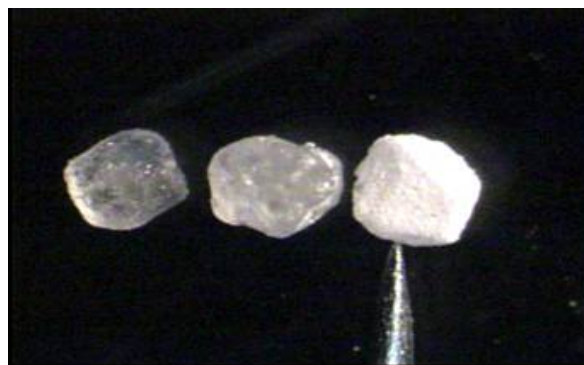
شکل ۳ مقایسه بلور اسید سیتریک تیمار نشده (چپ)؛ اسید سیتریک آغشته به پودر کازئین (وسط)؛ و بلور اسید سیتریک پوشش دار شده با کازئین (راست) توسط امواج مایکروویو در مدت ۲۵۰ ثانیه (تصویربرداری شده توسط دوچشمی آزمایشگاهی با بزرگ نمایی ۱/۵).
