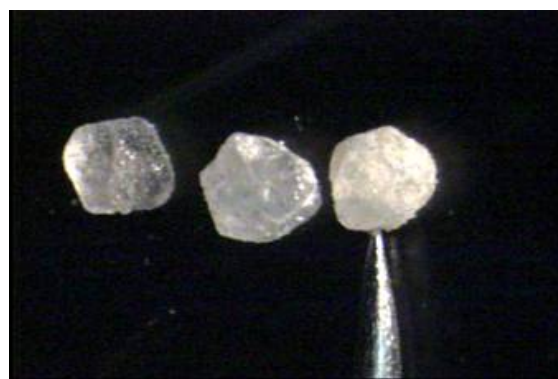
شکل ۷ مقایسه بلور اسید سیتریک تیمار نشده (راست)؛ اسید سیتریک آغشته به پکتین با درجه ی متوکسیل پائین (۹/۵٪) (وسط)؛ بلور اسید سیتریک پوشش دار شده با پکتین با درجه ی متوکسیل پائین (۹/۵٪) (راست) توسط امواج مایکروویو در مدت ۲۰۰ ثانیه (تصویربرداری شده توسط دوچشمی آزمایشگاهی با بزرگ نمایی ۱/۵).
