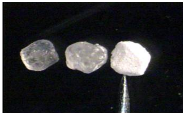
شکل ۳ مقایسه بلور اسید سیتریک تیمار نشده (چپ)؛ اسید سیتریک آغشته به پودر کازئین (وسط)؛ و بلور اسید سیتریک پوشش دار شده با کازئین (راست) توسط امواج میکروویو در مدت ۲۵۰ ثانیه (تصویربرداری شده توسط دوچشمی آزمایشگاهی با بزرگ نمایی ۱/۵).
