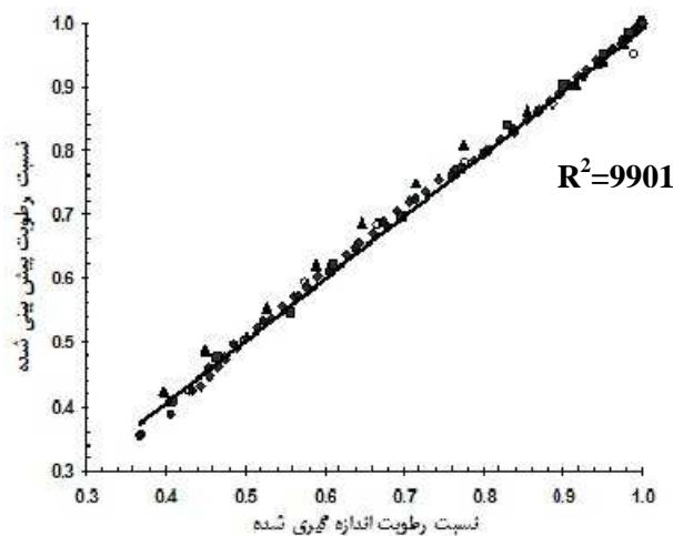
شکل ۷ مقایسه نسبت رطوبت اندازه گیری شده و پیش‌بینی شده توسط مدل میدیلی برای خشک کردن آلومینیوم در تیمارهای مختلف
