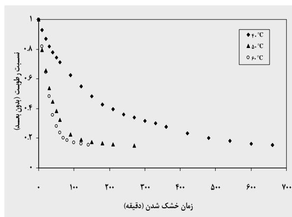
شکل ۴ تغییرات نسبت رطوبت بر حسب زمان در سطوح مختلف دمایی و سرعت هوای ورودی به خشک کن در حالت بدون بازگردش هوای گرم
