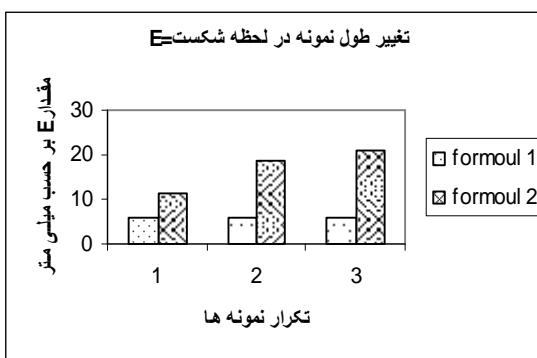
نمودار 1 میزان تغییر طول نمونه در لحظه شکست
