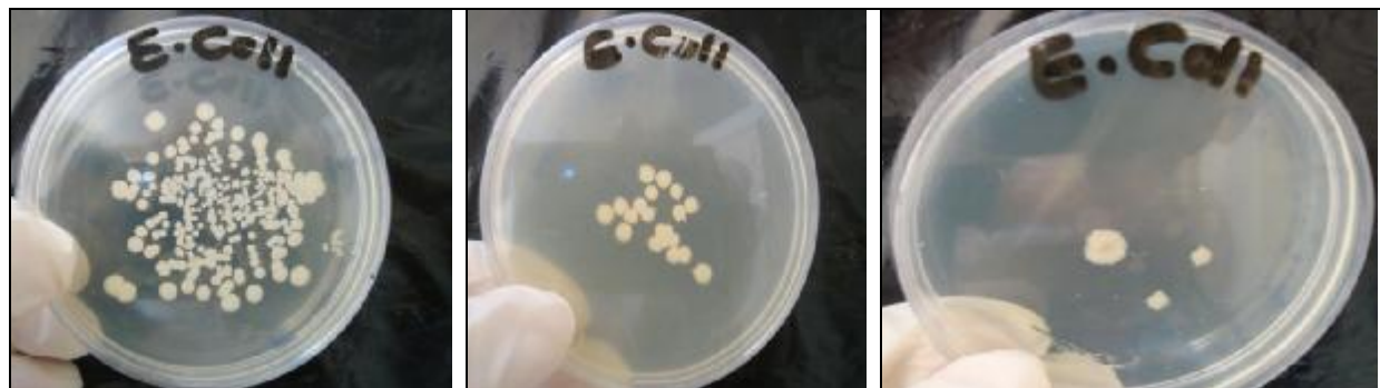
شکل 7 تصاویر پلیت های آزمون بررسی خاصیت ضد میکروبی قطعات سفال محتوی نانو ذرات نقره بر روی اشریشیاکلی به ترتیب از چپ به راست بعد از مدت 4، 8 و 24 ساعت
