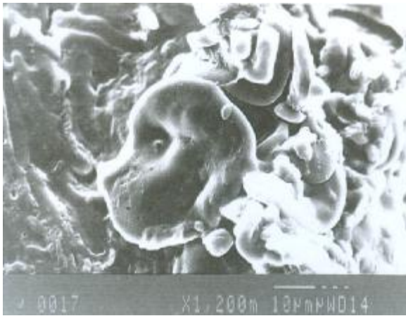
شکل 25 ساختمان میکروسکوپی نان سنگک 3 روز مانده، کریستاله شدن گرانول نشاسته با بزرگنمایی بزرگتر کاملاً مشهود است
